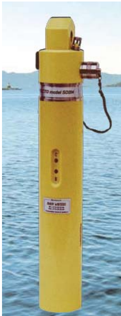
Figur 2. SAIV SD 204 ble brukt til måling av salinitets- og temperaturprofiler.
