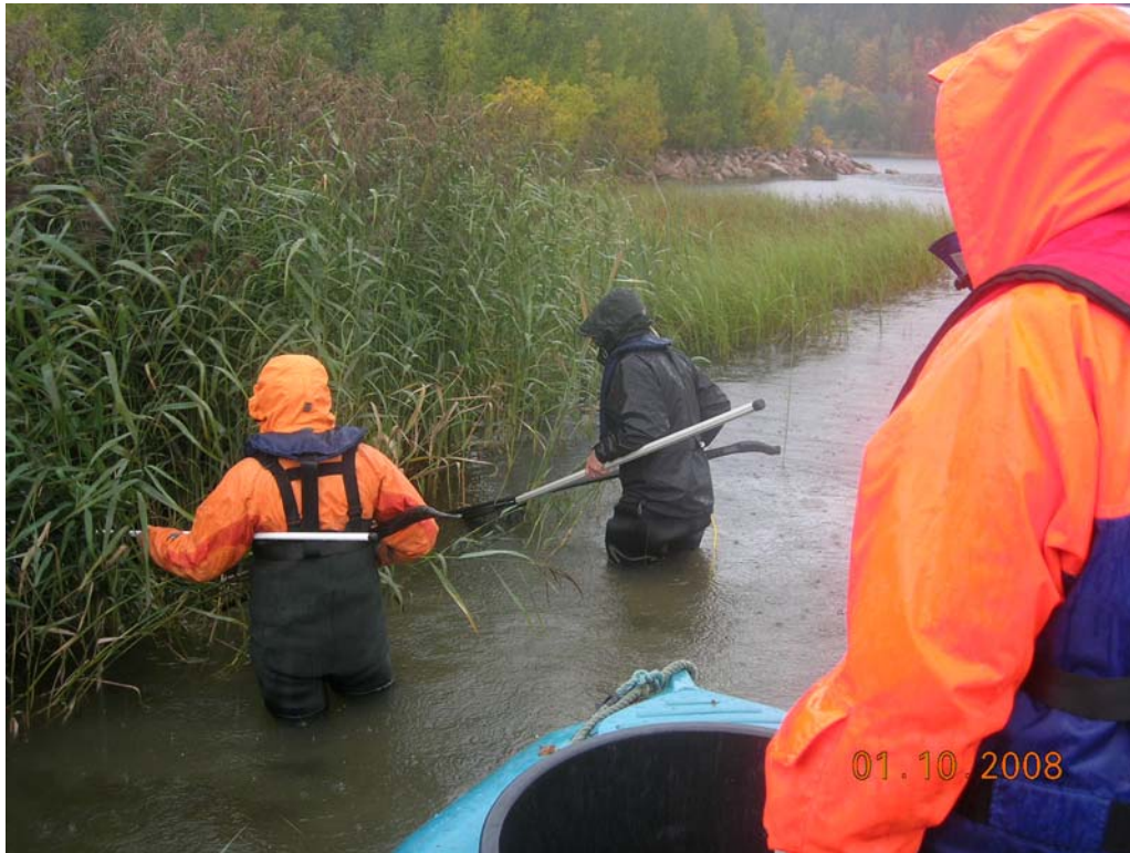
Figur 9. Eletrofiske langs sivbelte i Engersandbukta. Strømgeneratoren og transformatoren står i båten. De to fiskerne holder hver sin anode i høyre hånd og en finmasket håv i venstre hånd til å plukke fram fisk som har blitt tiltrukket og svimeslått av anoden.
