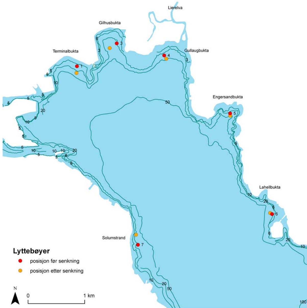
Figur 12. Plassering av de 7 lyttebøyerne (VR2w) brukt til logging av telemetridata fra fisk merket med akustiske sendere. Stasjon 3 ble fra oktober 2008 kuttet ut da all fisk i Gilhusbukta ble fanget opp av Stasjon 2 lyttebøyen. Senkningsposisjonene referer til endrede posisjoner for å senke bøyerne under isen om vinteren.
