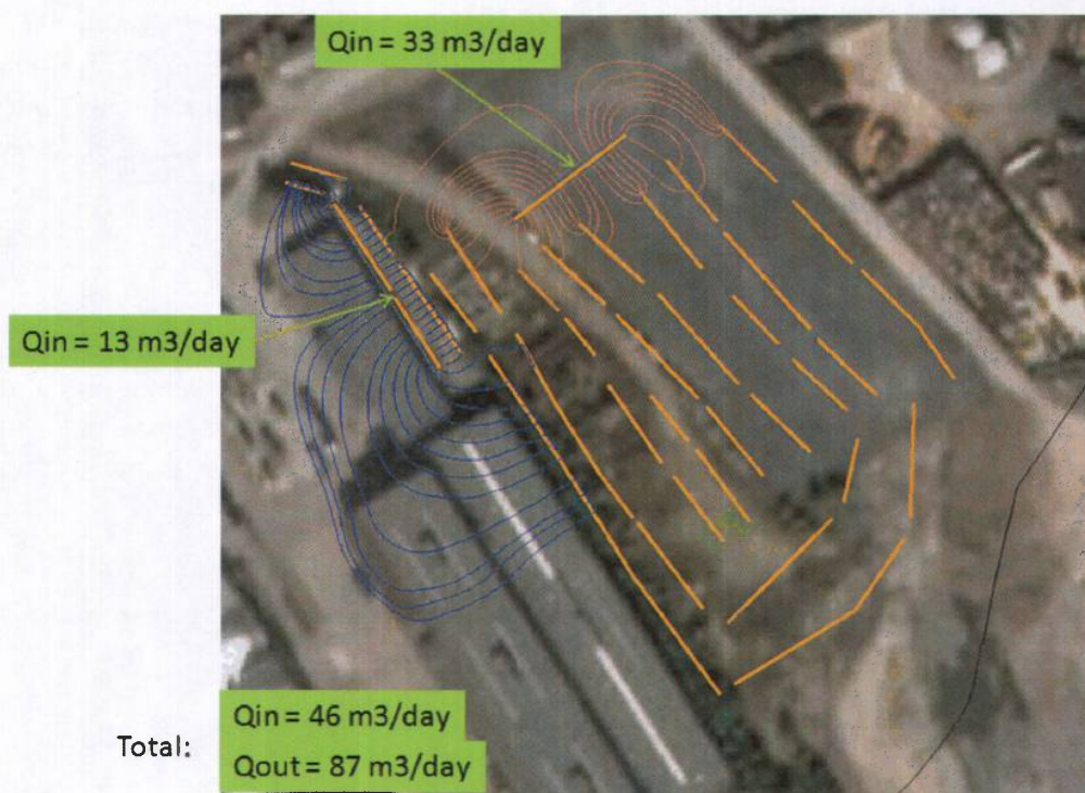
Figur 2, Grunnvannstrøm ved normal tidevann og pumping av drengrofter Fluid particle pathlines from injection trenches (high tide)
